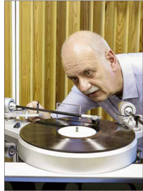
Die Tonarme wurden auch in der Höhe penibel per Anlageblock mit Peilstrichen eingestellt.
