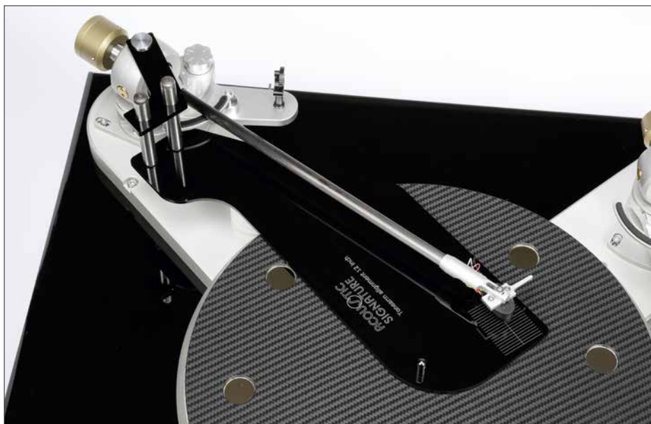
Zu jedem Tonarm gehört eine Schablone, die auf der Tellerachse ihren Fixpunkt hat. Sie definiert den Abstand des Armdrehpunkts zu dieser sowie den Überhang und die Kröpfung des Tonabnehmers.
