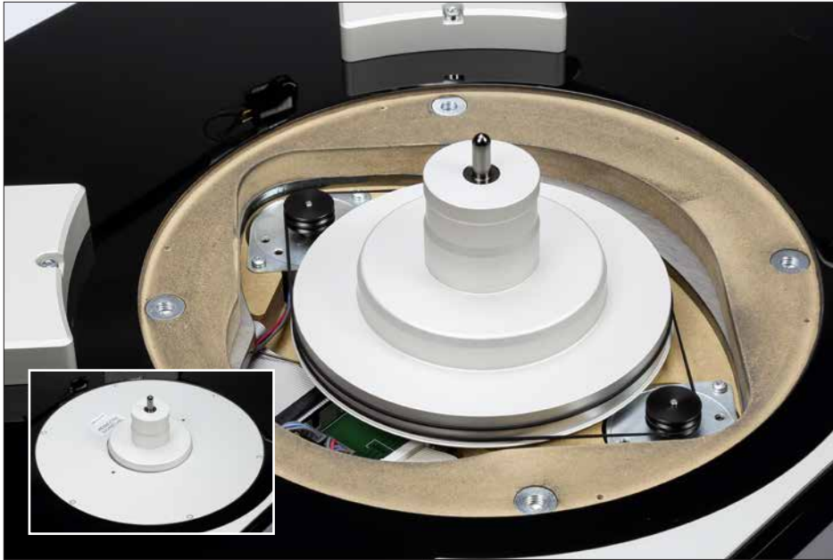
Nach dem Entfernen einer Aluminiumabdeckung (I.) ist der Blick auf den massiven Innenteller sowie die beiden einander gegenüberliegenden Motoren frei, die diesen mit kurzen Riemen umschlingen.
