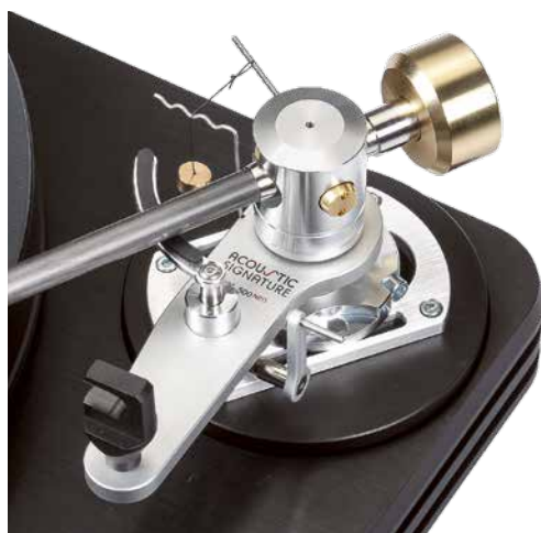
Der extrem leichtgängige, kardanisch gelagerte Tonarm hat ein Messinggewicht ohne Skala, was bei der Einstellung eine Waage erfordert.
