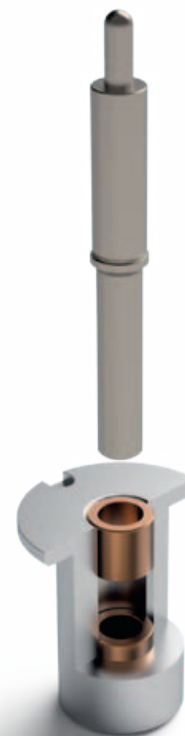
Die Achse aus vakuumgehärtetem Edelstahl ist mit einer Plasmabeschichtung versehen und ruht auf einer Kugel aus Wolframkarbid.
