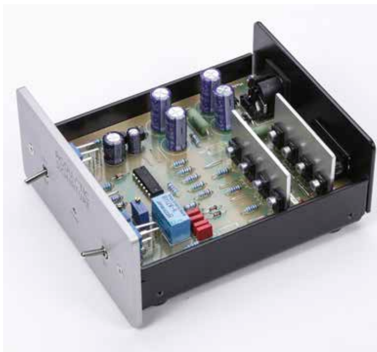
Die Antriebssteuerung wird aus einem separaten Netzteil gespeist und soll den Motor mittels ihrer acht „Leistungstransistoren“ extrem sauber und stabil versorgen.
