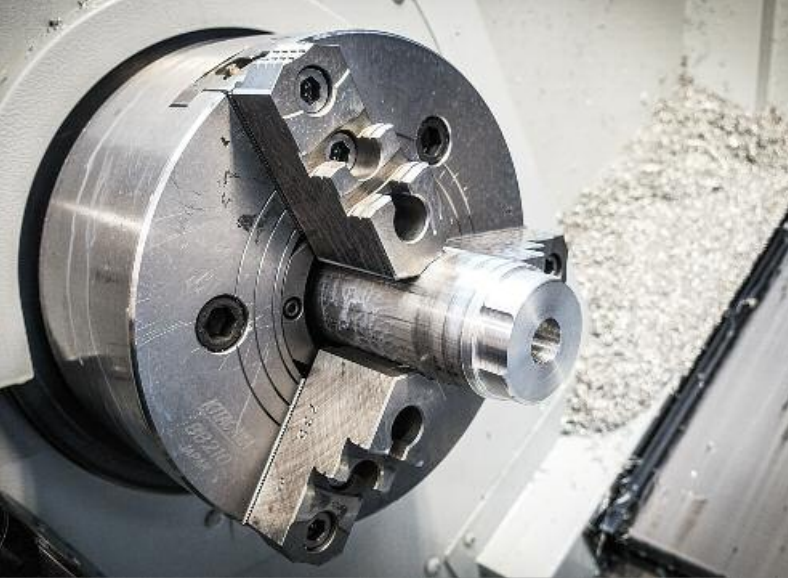
Das sogenannte Backenfutter, das in der CNC-Drehmaschine zum Klemmen der Werkstücke verwendet wird
