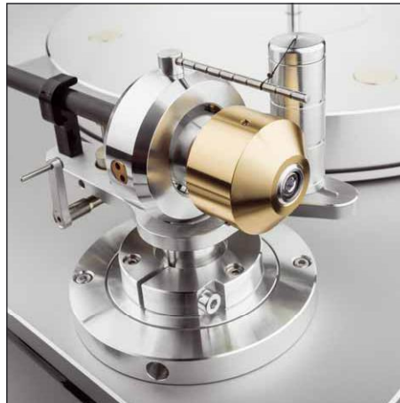
Das Gegengewicht ist zur Einstellung der Auflagekraft verdrehbar
