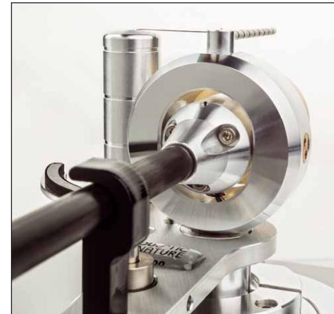
Per Klemmschraube ist das Armrohr im Lagerblock lösbar; so kann man den Azimut verstellen
