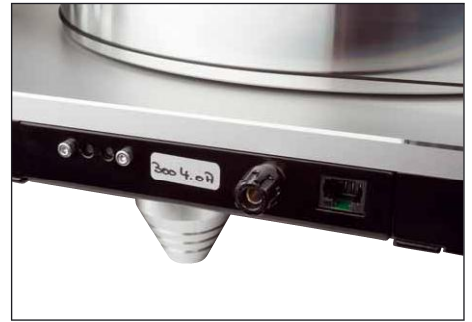
Keine Angst: Die Netzwerkbuchse dient nur dem Anschluss des Netzteils
