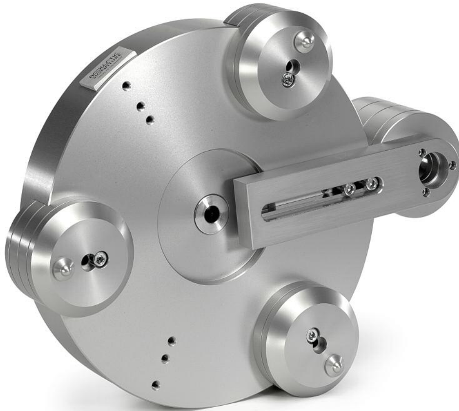
Grundstock des Thunders ist eine 70 Millimeter hohe, aus dem Vollen gefräste Aluplatte, die bis zu drei stufenlos in der Länge verstellbare Basen für Tonarme von neun bis zwölf Zoll aufnimmt
